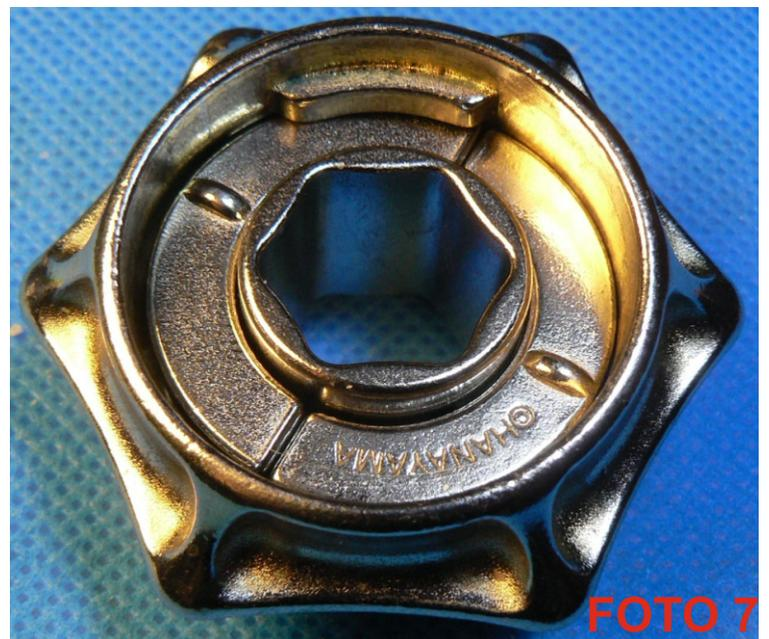
Girando a la derecha el anillo interior llegaremos a la figura de la foto 6. Empujando hacia abajo el anillo interior y girándolo a la izquierda llegaremos a la posición de la foto 7.
